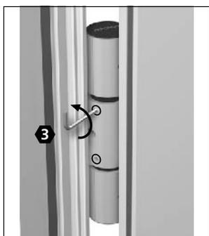
2. Gewindestifte mit einer 1/2-Umdrehung lösen.
